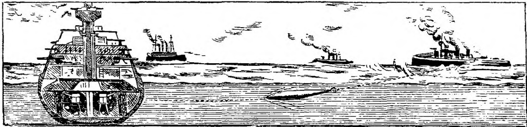
Minenschuß. Die durch Punkte ange deutete Linie bezeichnet die Flugbahn der abgeschossenen Mine.
