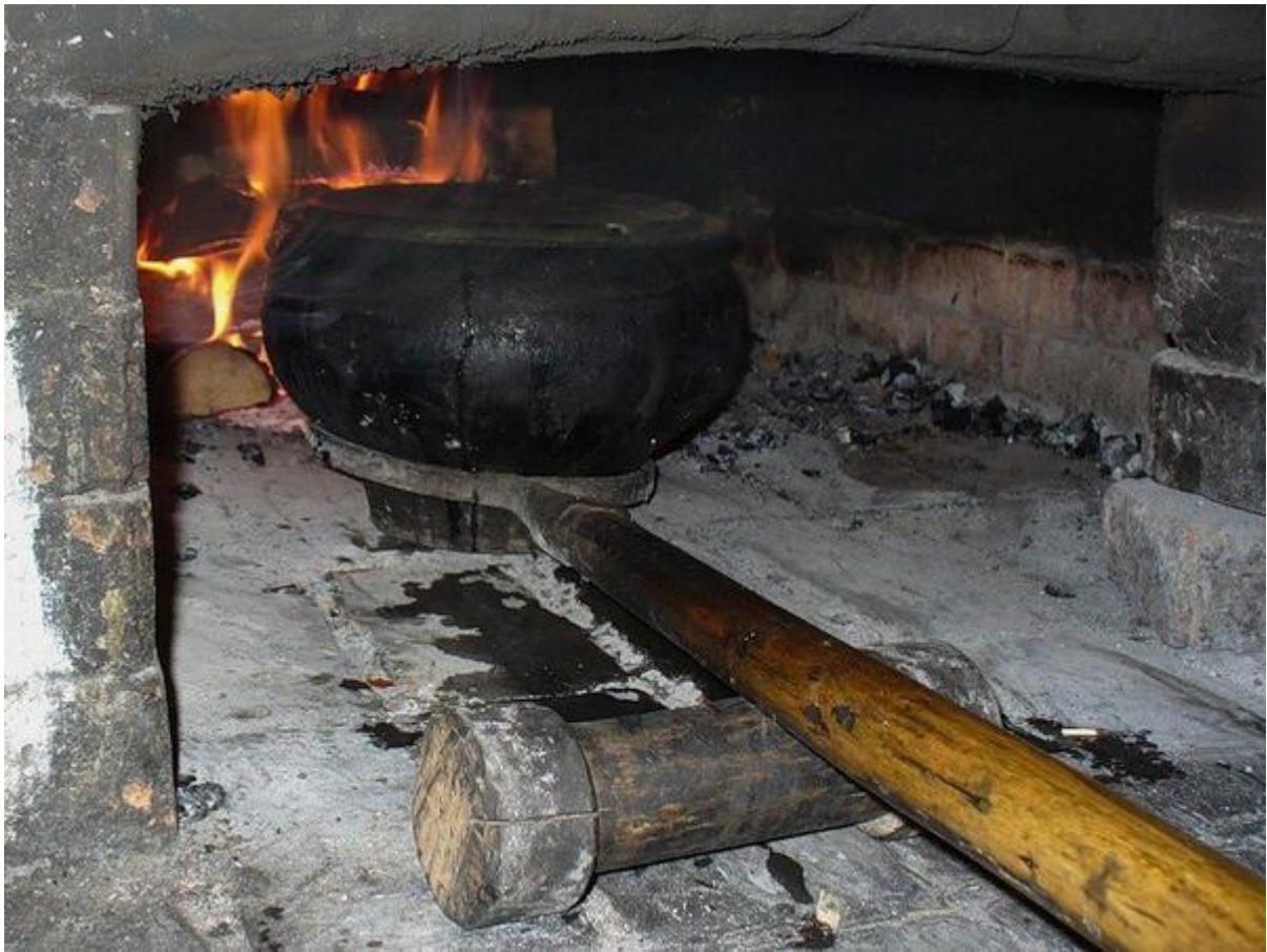
Принцип работы ухвата с валиком (из открытых интернет-источников)
